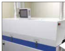
部品を実装し リフローをかける
