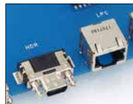
SMT品と同時に リフローでの半田付けを実現
